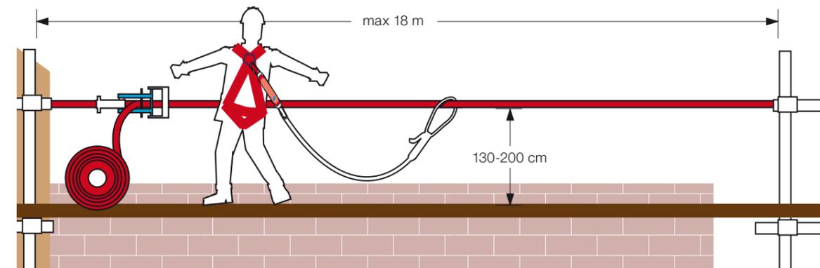
In alcune situazioni non solo è impossibile installare un sistema anticaduta orizzontale fisso, ma è preferibile utilizzare un sistema orizzontale temporaneo che, oltre a fornire le adeguate garanzie di sicurezza, permette di essere facilmente installato e rimosso in pochi minuti non appena terminato il lavoro. Alcune di queste situazioni tipiche sono:
